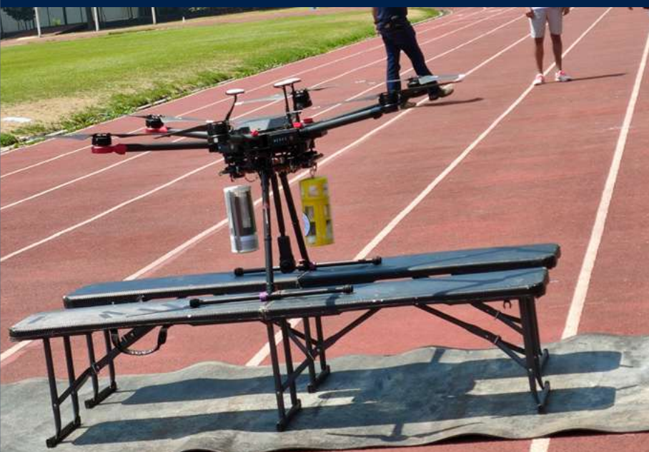
Satélites enlatados colocados en el drone.
