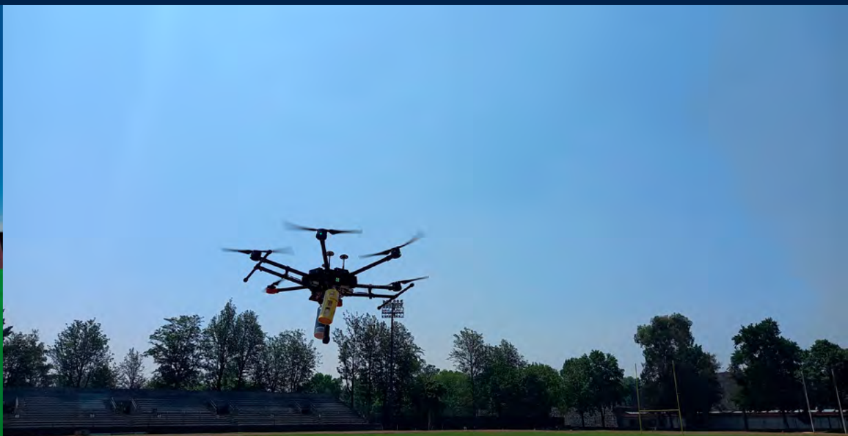
Satélites enlatados colocados en el drone para su elevación a 400 metros de altitud.
